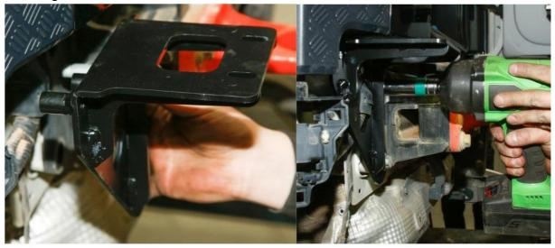
Die untere Leiterhalterung muss über die Oberkante des hinteren Stoßfängers herausragen. Hier sind 3 Kunststoffbauteile in drei Schichten aneinander befestigt. Lösen Sie die gesteckten Teile vorsichtig voneinander und ziehen Sie auch den äußeren lackierten Teil, der mit doppelseitigem Klebeband befestigt ist, vorsichtig ab.
