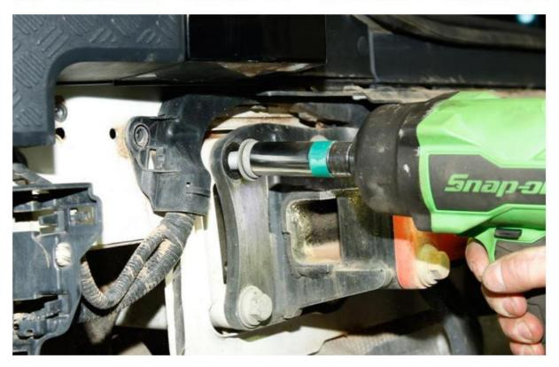
Befestigen Sie die untere Leiterhalterung mit den Originalschrauben der Halterung der Anhängerkupplung und den mitgelieferten neuen M8x45-Schrauben und Unterlegscheiben.
