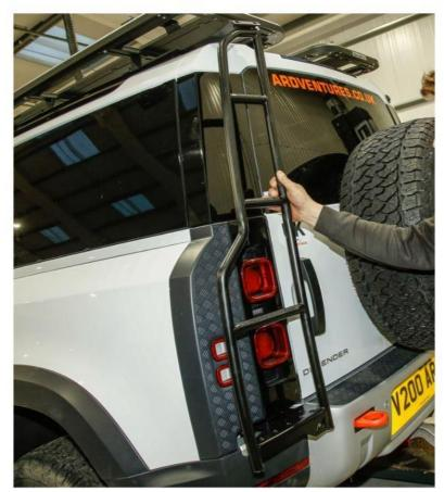
Befestigen Sie die Leiter lose mit den mitgelieferten M8-Schrauben und den Unterlegscheiben an der oberen und unteren Halterung.
