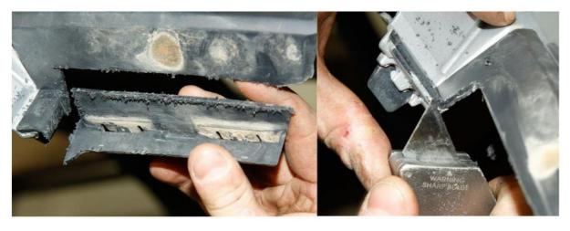
Das Endergebnis sollte so aussehen. Die lackierte Außenabdeckung muss ebenfalls zurechtgeschnitten werden, um die Leiterhalterung auszusparen. Dann wird die Stoßstangenaußenseite mit doppelseitigem Klebeband wieder befestigt. Beim Probemontieren des hinteren Stoßfängers sollte kein Widerstand zu spüren sein. Der eingeschnittene Kunststoff sollte frei anliegen, ohne dass das Material sich verzieht oder verbiegt.
